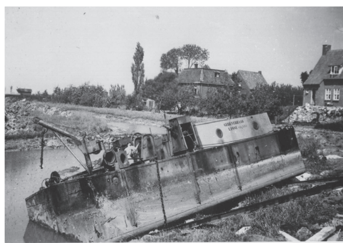
De zandzuiger is klaar met zijn werk en ligt gereed om uit het water gehaald te worden.
